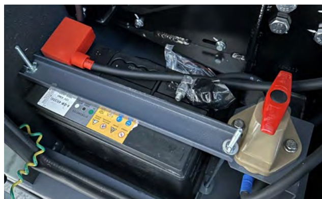
Izolator de baterie pentru întreținere și depozitare
