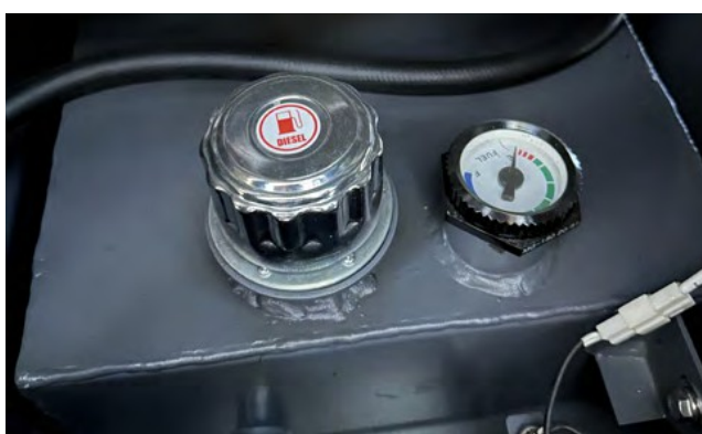
Rezervor cu punct de alimentare larg și indicator de nivel al combustibilului
