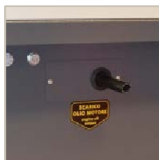
Punct extern de scurgere a uleiului permite schimbarea ușoară a uleiului
