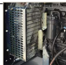
Căldură și rotație protecții pentru piese pentru a preveni rănirea utilizatorului
